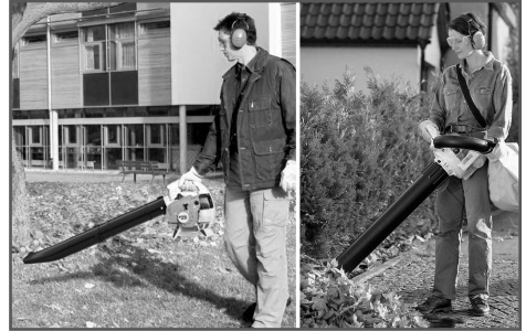
Рис. 9 Положение оператора при работе воздуходувным устройством
